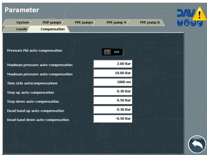
Questa pagina serve per regolare il PID di compensazione e non deve assolutamente essere modificata. Importante è che il selettore rimanga sempre su "OFF", così da non attivare il PID di autocompensazione.
