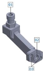
Componente che serve per collegare le siringhe alla pompa PCP. Il punto 01 ha un filetto luer-lock ed è dove si collega la siringa; il punto 02 è dove esce il fluido per entrare nella pompa PCP, mentre i punti 03 sono fori passanti per collegare l'adattatore alla pompa. Ci possono essere di dimensioni diverse, in base alle dimensioni della pompa stessa.
