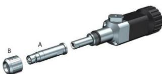
Tramite chiave fissa fornita, rimuovere l'adattatore luer lock (A) o equivalente e riporlo da una parte. Una volta rimosso, togliere la ghiera (B) utilizzando la stessa chiave fissa e, se presente, rimuovere la bussola statore.
