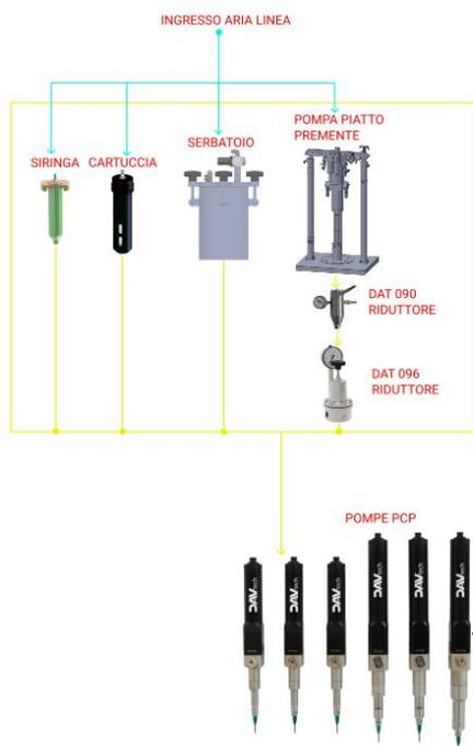
Figura 02 – Schema di collegamento
