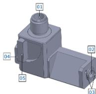
Componente che serve per collegare i porta-cartucce alla pompa PCP. Ci sono sia piccoli che grandi, in base alle dimensioni della pompa stessa. Il punto 01 è il nipplo di interfacciamento tra cartuccia e adattatore; il punto 02 è dove esce il fluido per entrare nella pompa PCP; i punti 03 sono fori passanti per collegare l'adattatore alla pompa; il punto 04 serve per eseguire lo spurgo del fluido durante il cambio della cartuccia; il punto 05 serve per bloccare il nipplo in posizione.
