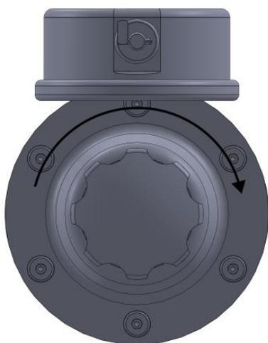
Se si gira in senso orario, si aumenta la pressione all'interno del riduttore di pressione; quindi, si passa da una pressione inferiore ad una superiore.
