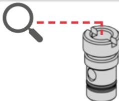
Controllare l'usura e lo stato dei componenti in posizione 15, 16, 17 e 18 del [capitolo 2.1](#) e, se necessario, eseguire una sostituzione. In qualsiasi caso, lubrificare sempre i componenti prima di rimontarli con grasso o olio a base di silicone specifico per o-ring.
