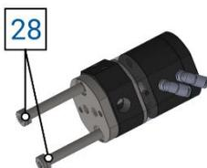
Inserire le viti calibrate che tengono il corpo valvola (28). Una volta tirate queste viti, il corpo valvola è sigillato e si può anche muovere senza paura che l'olio fuoriesca dalla valvola.
