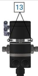
Per eseguire il rabbocco dell'olio, togliere le viti di chiusura delle camere (13), inserire olio di vaselina o equivalente, basta che sia trasparente, riempire a 3/4 una camera e chiuderla con la vite e rondella (14) e poi fare l'altra camera allo stesso modo.
