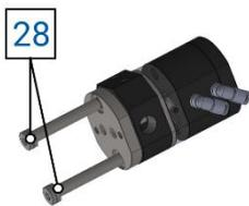
Rimuovere le viti calibrate che tengono il corpo valvola (28). Si devono svitare le viti in maniera alternata ed uguale (massimo 1/4 di giro alla volta).
