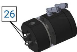
Avvitare le punte degli spilli appena assemblate all'interno degli spilli stessi. Per farlo, utilizzare una chiave a brugola particolare, con il taglio centrale. Arrivare in battuta e poi eseguire un altro 1/2 giro, così da comprimere le bocce.
