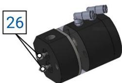
Rimuovere le due viti per spilli (26) con boccola e rondella.
