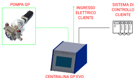
Figura 11 – Esempio di collegamento controller GP EVO
