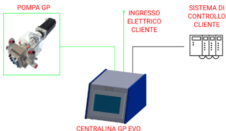
Figura 11 – Esempio di collegamento controller GP EVO
