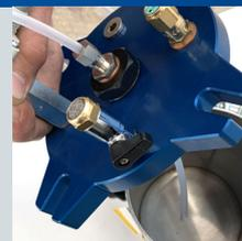
Inserire il tubo fino a toccare il fondo del serbatoio.
