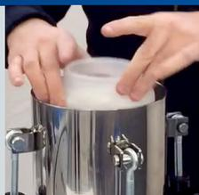
Inserire barattolo con prodotto o direttamente il fluido all'interno del serbatoio.
