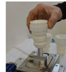
Stazione manuale di ingrassaggio volumetrico particolare in gomma. Manual greasing system for rubber part.
