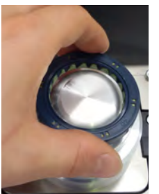
Stazione di dosatura volumetrica grasso manuale con mini-PLC integrato per controllo oggettivazione avvenuta dosatura e sistema di setup rapido senza attrezzi. Volumetric greasing system with mini-PLC on seals. Check of the dispensing result and fast setup without tools.
