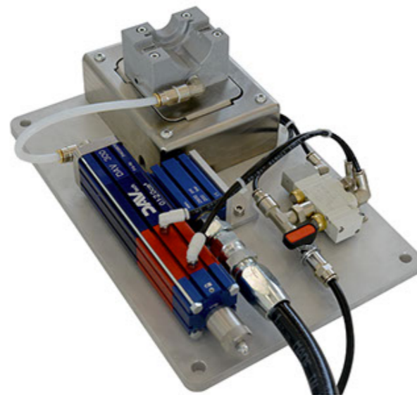
Stazione manuale per dosaggio volumetrico grasso su componenti automotive. Manual system for grease volumetric dispensing on automotive parts.
