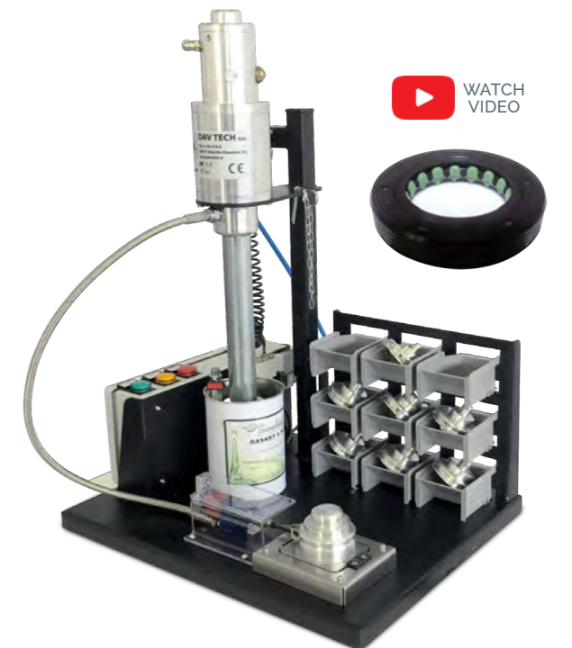
Stazione di dosatura volumetrica grasso manuale con mini-PLC integrato per controllo oggettivazione avvenuta dosatura e sistema di setup rapido senza attrezzi. Volumetric greasing system with mini-PLC on seals. Check of the dispensing result and fast setup without tools.
