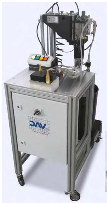
Banchi di ingrassaggio volumetrico su riduttore GPL con oggettivazione quantità dispensata e controllo presenza pezzo.
