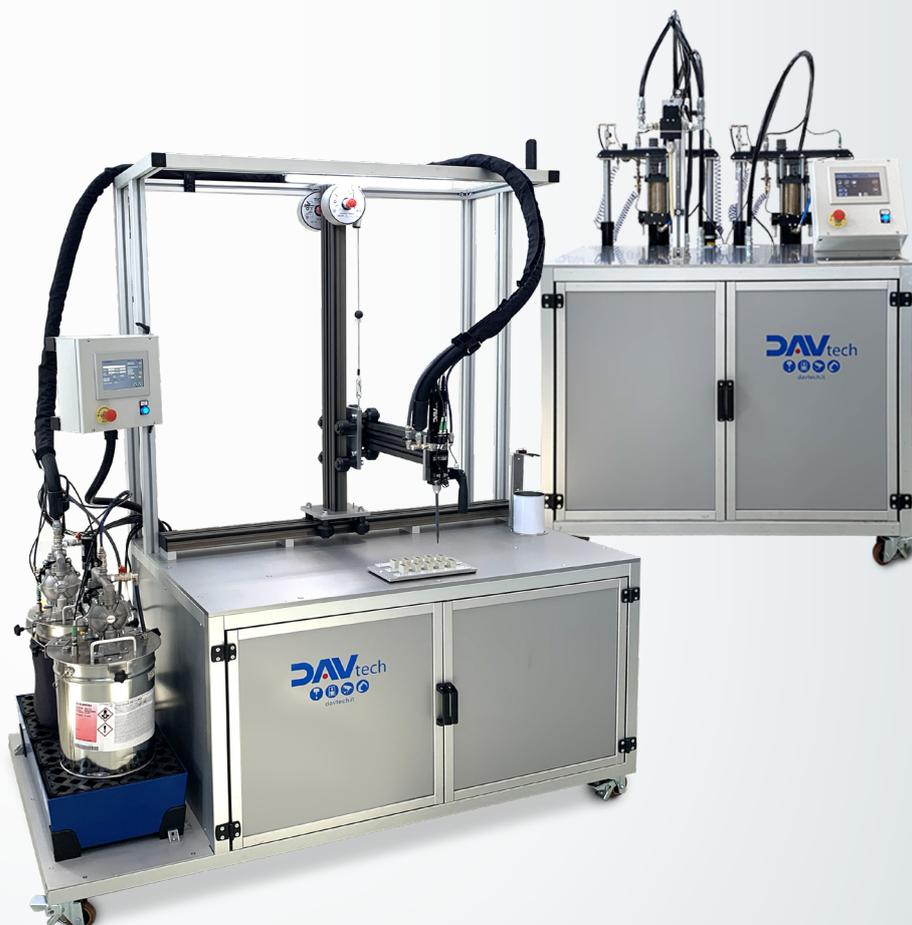
Tutte le nostre applicazioni si basano su sistemi di **proporzionatura volumetrica** gestita da **Controller** e/o **PLC**, questo permette di controllare con la massima precisione il processo e di garantirne l'affidabilità.
