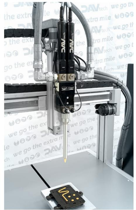
Die PDP-Pumpen revolutionieren das Konzept der Präzisionsdosierung von **Zweikomponenten-Flüssigkeiten**. Dosier- und Mischvorgänge sind mit einem einzigen Gerät möglich, wodurch Ergebnisse erzielt werden können, die mit Kolbensystemen oder anderen Typen überlegen sind.
