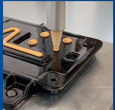
PCP und PDP Volumetrische Pumpen für die Mikrodosierung
