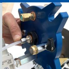
Das Rilsan-Rohr durch das spitzbogenförmige Loch im Deckel führen.
