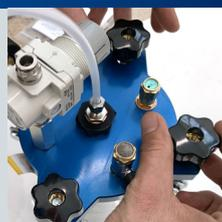
Den Deckel wieder aufsetzen und durch Anziehen der 4 Flügelmuttern befestigen.
