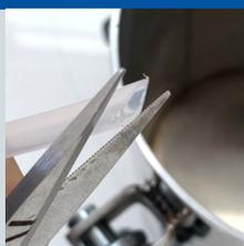
Schneiden Sie das Rilsan-Rohr unter einem Winkel von 45° ab.
