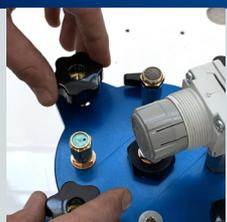
Den Behälter durch Lösen der 4 Flügelmuttern und Anheben des Deckels öffnen.
